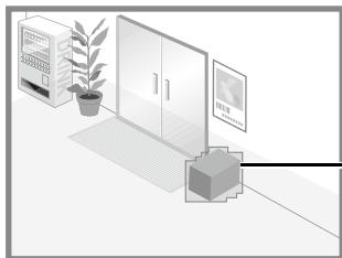
置き去り検知された物体の輪郭線
