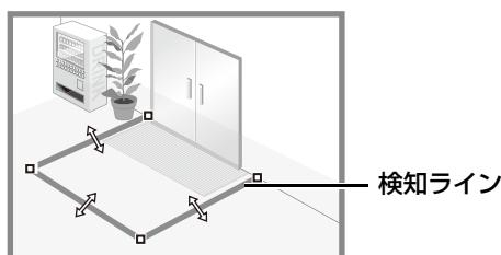
最大32頂点の折れ線で検知ラインを設定できます。
