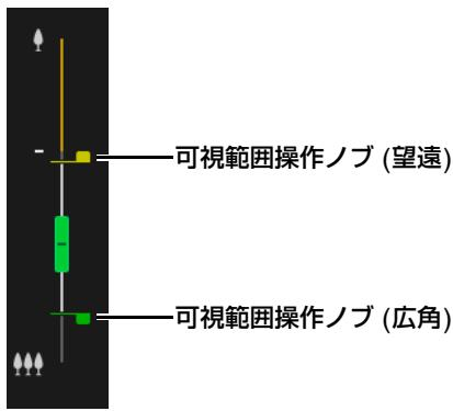
パノラマ画面に表示される枠をドラッグして変形させ、可視範囲を設定します。
