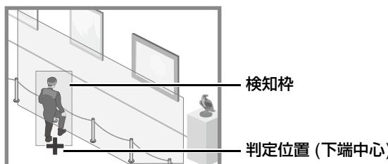
**4** [物体の大きさ(%)] で、検知する動体の大きさを設定する
