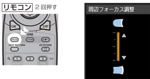
本体の【LENS】ボタンは、押すたびにレンズ関連の画面表示が切り換わります。【LENS】ボタンを2回押すと、周辺フォーカス調整画面が表示されます。
