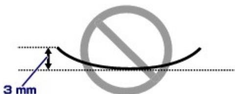
1. 下の図のように、対角線上の端を、反りと逆方向に丸める
