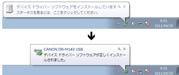
スキャナーがコンピューターに正常に接続されているときは、タスクバーの (CaptureOnTouch) アイコンが次のように表示されます。
