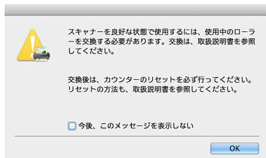
このメッセージ画面が表示されるようになったら、交換ローラーキットをお買い求めのうえ、キットに含まれる消耗品（給紙ローラーと分離ローラー）に交換してください。交換ローラーキットについては [72 ページ](#)を参照してください。
