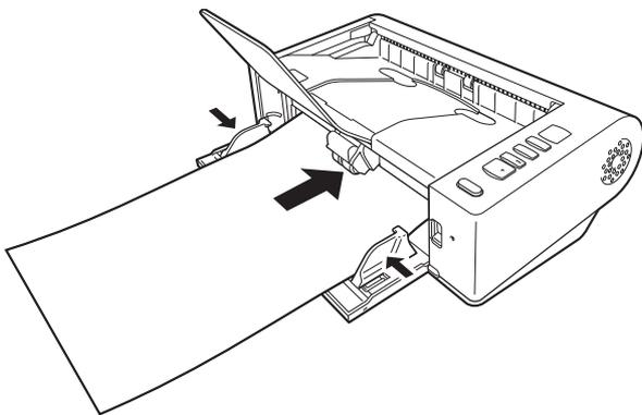
原稿をセットしたら、原稿ガイドを原稿の両端に合わせてください。
