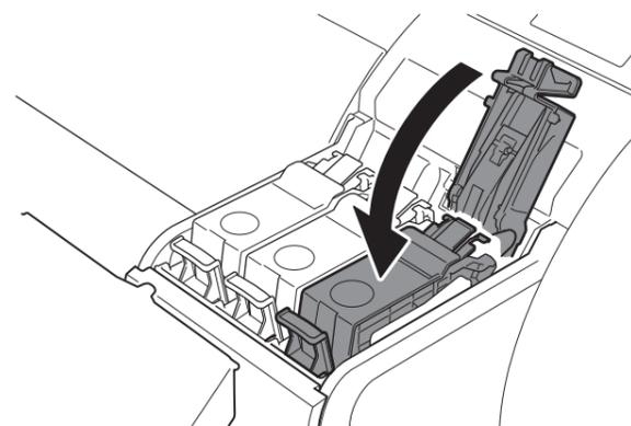
Asegúrese de revisar las etiquetas, y de comprobar que los depósitos de tinta se hayan instalado correctamente.
