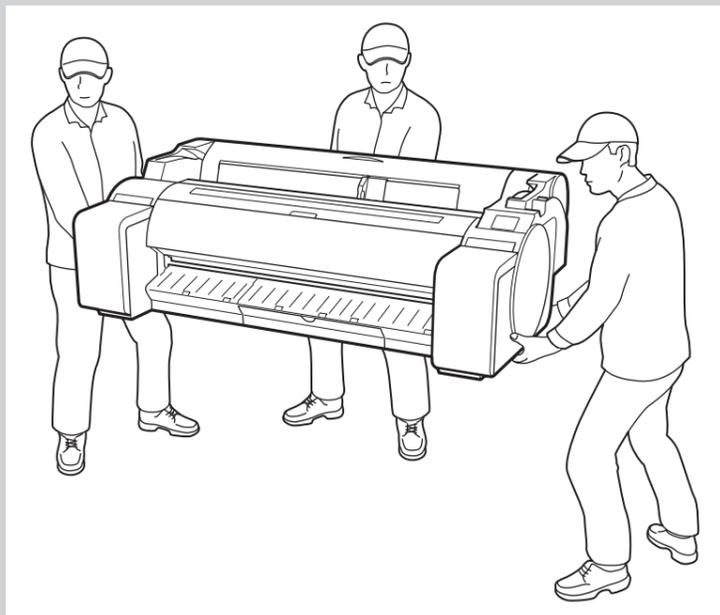
• Ao mover a impressora, segure com firmeza nas alças de transporte (A) sob cada lado e na parte de trás. Segurar a impressora em outras posições é perigoso e oferece risco de ferimentos e danos se a impressora cair.
