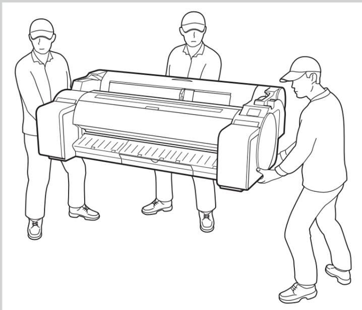
• Al mover la impresora, sujete con firmeza las asas (A) situadas en ambos laterales y en la parte de atrás. Sostener la impresora desde otras posiciones es peligroso y podría causar lesiones y daños si la impresora cae.
