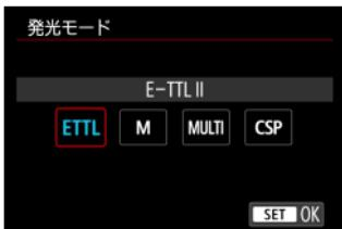
【E-TTL II】は、ストロボの自動露出撮影ができる、EL／EXスピードライトの標準的なモードです。
