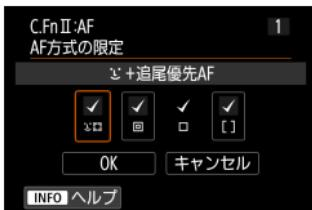
AF方式の選択項目を、使用するAF方式だけに限定することができます。
