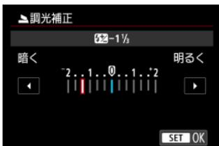
露出補正と同じ感覚で、内蔵ストロボの発光量を調整することができます(図288)。
