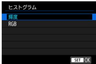
ヒストグラムには、露出レベルの傾向と全体の階調を確認できる輝度表示と、色の飽和と階調を確認できるRGB表示があります。[▶ : 再生情報表示設定] の画面の左下に [INFO] が表示されているときに、<INFO> ボタンを押すと、表示するヒストグラムを切り換えることができます。
