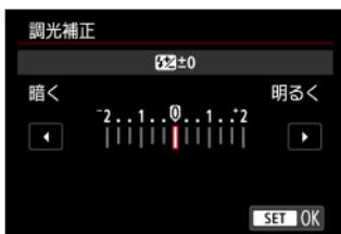
露出補正と同じ感覚で、外部ストロボの発光量を調整することができます。
