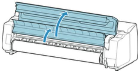
6. 両手でロールホルダーを矢印方向に回してロール紙を巻き取る
