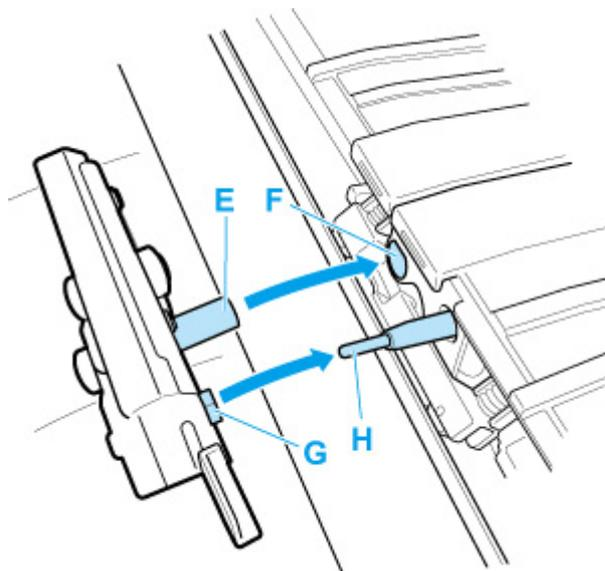
9. 交換用のカッターブレードに付属の固定用の部品を、カッターブレードの中央に合わせて取り付ける
