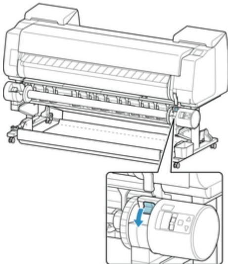
9. ロールユニット上面の給紙フラップスイッチを、スイッチの指標（A）が巻き取りアイコン上の●（B）の位置に合うように切り替える
