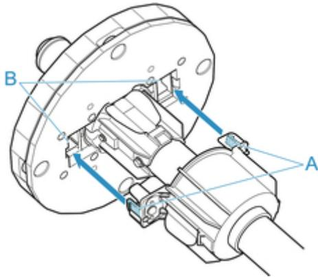
3. 図のように、ロール紙の先端を手前側に向けて、ロール紙の右側からロールホルダーを差し込み、ロール紙が、ロールホルダーのフランジ (A) に隙間なく突き当たるまでしっかりと差し込む
