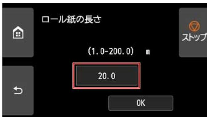
2. タッチスクリーンに表示されたテンキーをタップしてロール紙の長さを入力し、[OK] をタップします。
