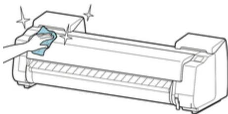
トップカバーと排紙ガイドを開き、用紙に触れる部分 (A,B)、センサー部分 (C)、トップカバー裏側の窓部分を清掃します。
