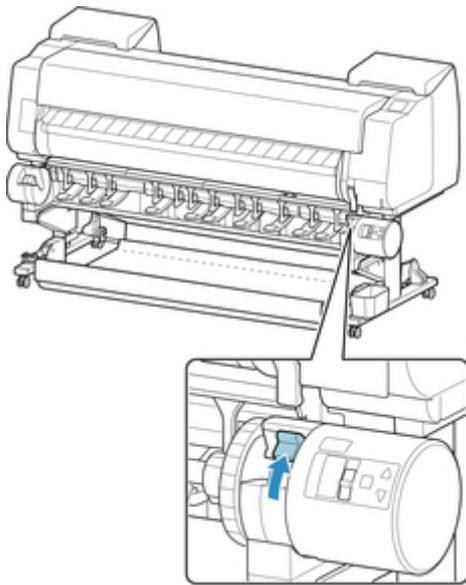
7. ロールホルダーの黒いギヤが左側にくるようにフランジ (A) の部分を持ち、ロールホルダーの軸をロールホルダースロットの左右のガイド溝 (B) に合わせてセットする
