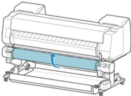
6. ロールユニットのロールホルダー固定スイッチを解除の位置に切り替える
