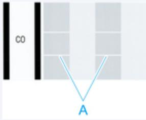
横線がかすれていたり抜けている場合は、プリントヘッドのクリーニングを実行してください。
