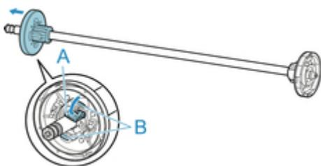
**3. 内径が3インチの紙管でロール紙を巻き取る場合は、ロールホルダーとホルダーストッパーに3インチ紙管アタッチメントを差し込む**
