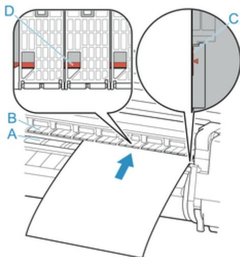
カット紙を差し込むと、自動的にプラテン表面に吸着します。
