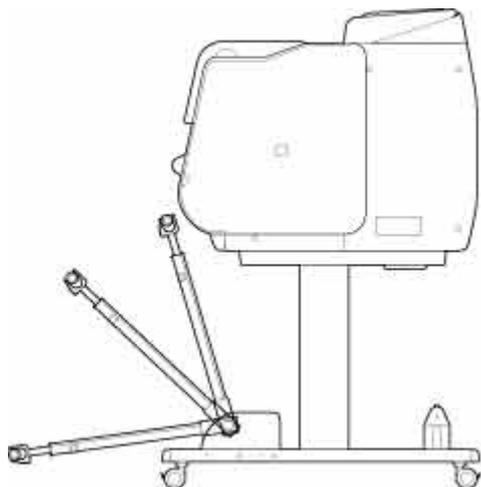
バスケットアームを固定する場合は、左右のバスケットアーム（A）にバスケット固定部材を取り付けてください。
