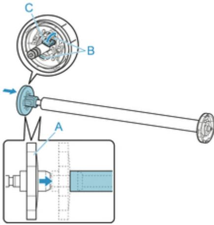
6. ロールユニットのロールホルダー固定スイッチを解除方向に切り替える
