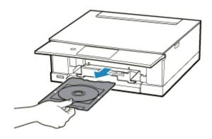
2. ストッパー(A)を押し下げ、プリンタブルディスクを多目的トレイのスリット(B)から 外して、取り外す
