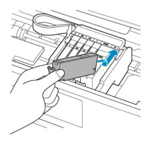
8. インクタンク上面を「カチッ」と音がするまでしっかり押して、インクタンクを固定する
