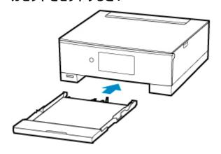
用紙のサイズが自動で検知され、プリンターに設定されます。
